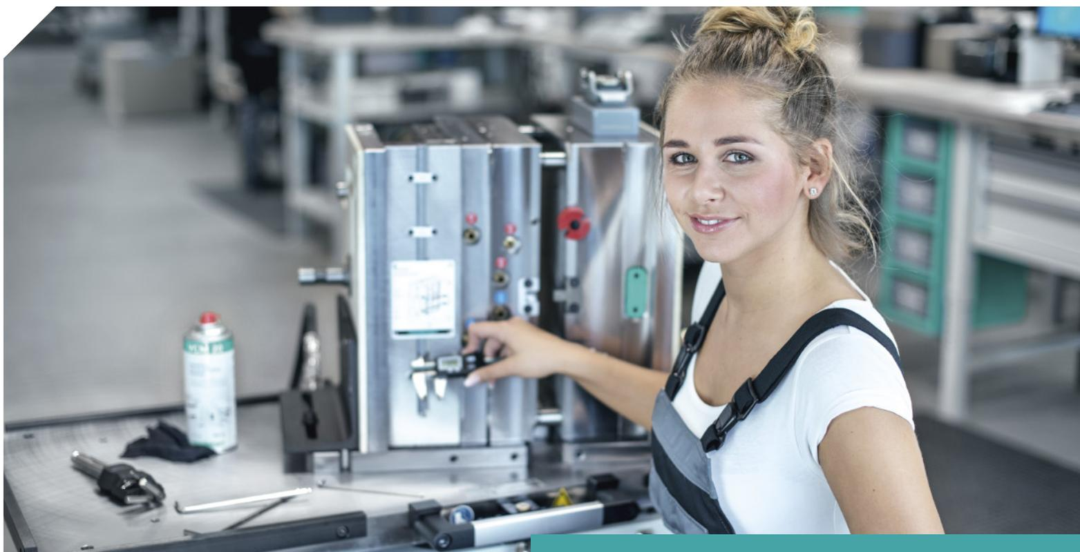
Il tavolino di montaggio H 4062 della Meusburger facilita i lavori di montaggio e riparazione degli stampi. Grazie a numerosi ugelli ad aria, si forma un cuscino d'aria nella parte sottostante la piastra in movimento, che consente il semplice movimento delle metà dello stampo. Entrambe le metà dello stampo sono accessibili senza bisogno di spostamenti e consentono una lavorazione efficiente. Ciò garantisce un risparmio di tempo e di costi durante l'intero processo di lavorazione.
